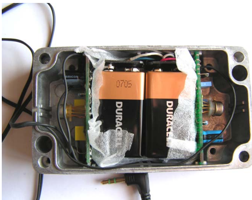
Рис. 15. Размещение генераторов GD1 и GD2 и автономных источников питания внутри корпуса.
